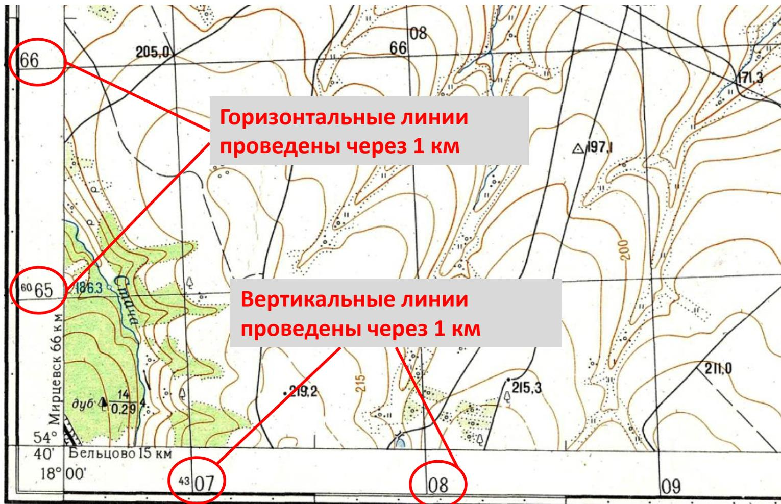
Линии километровой сетки на топографической карте проводятся через целое количество километров. Для данной карты линии километровой сетки проведены через 1 км и образуют квадраты размером 1x1 км.
